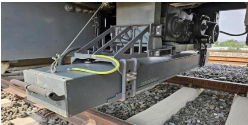
图 8：车载连续廓形测量设备
