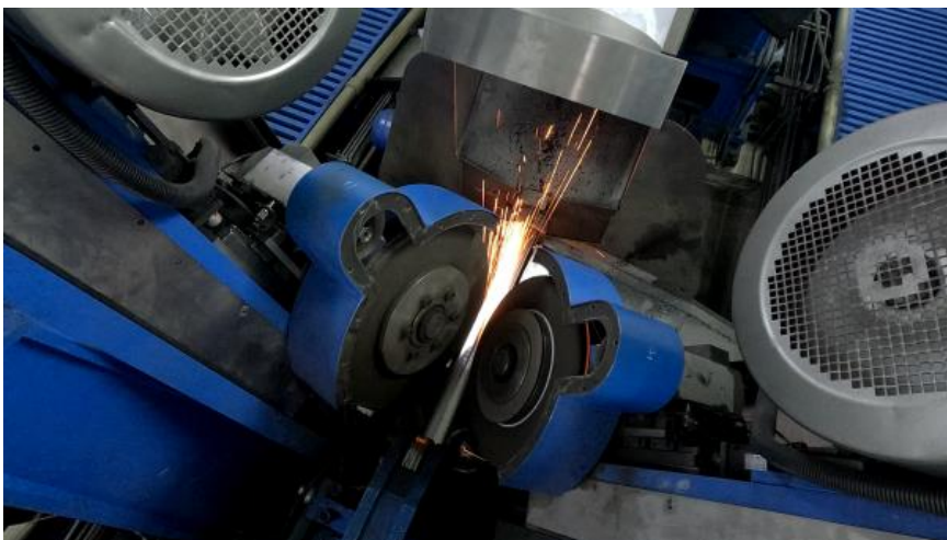
图 10：焊轨基地个性化钢轨廓形预打磨加工设备
